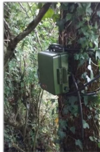
Figure 220 : Installation d'enregistreur continu SM4BAT © NCA Environnement
